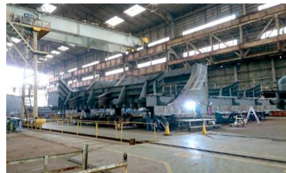
点検が終わったパーツを組み合わせ大きな船が出来上がります
